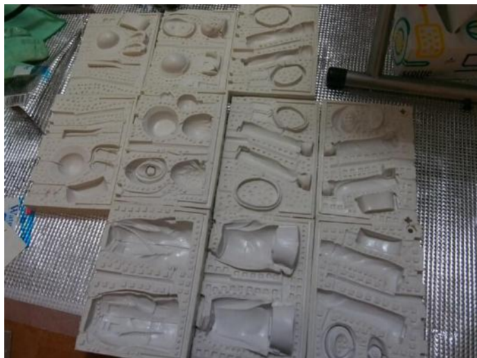
図表22 ガレージキットを製作する際に用いるシリコン型
